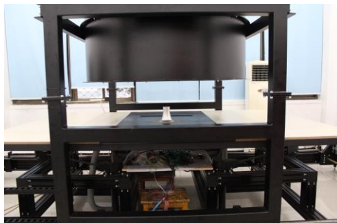
図 1 竜巻の影響を受ける冷却塔の風圧実験
